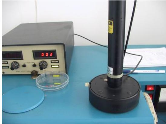
I. Una vez terminada la muestra (auto terminador corta la corriente o el tiempo agotado) presionar RAISE en AIR LOCK para subir el brazo
