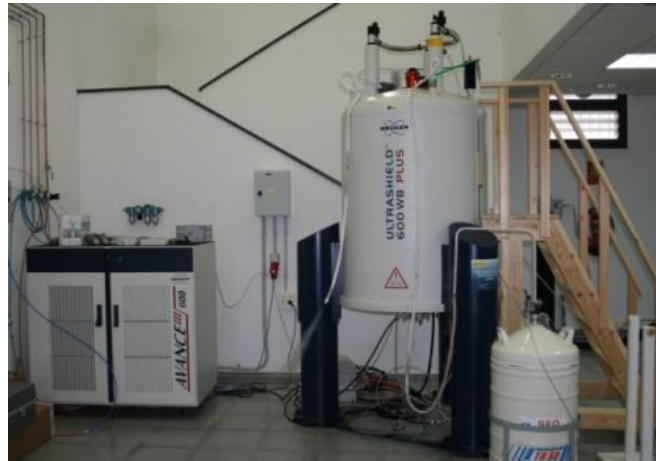
Figura 75: Detalle del espectrómetro Bruker Avance-600 WB de Sólidos
