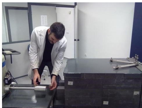
Figura 74: Santiago Hurtado, téc. de laboratorio del SGI RDI, cambiando una muestra en el detector gamma con geometría de pozo.
