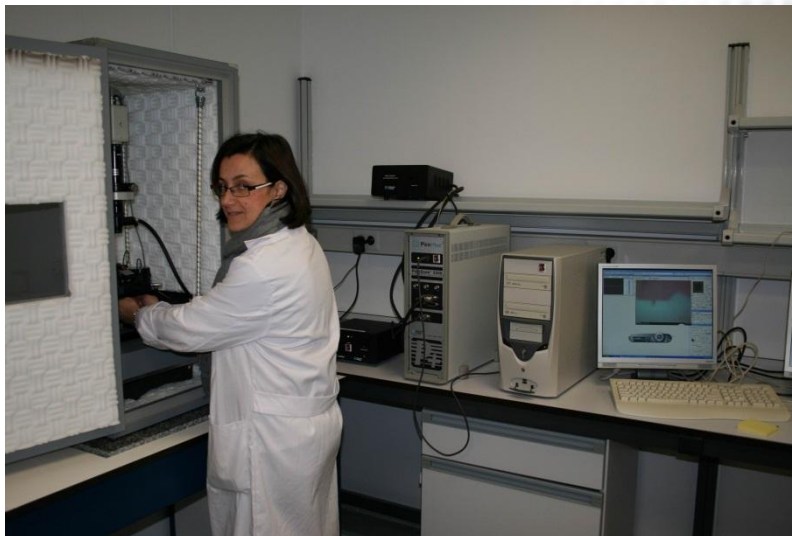
Figura 70: Consuelo Cerrillos, Titulada Superior de Apoyo a la Docencia e Investigación, en el microscopio de fuerza atómica/efecto túnel Molecular Imaging, Agilent PicoPlus 2500.
