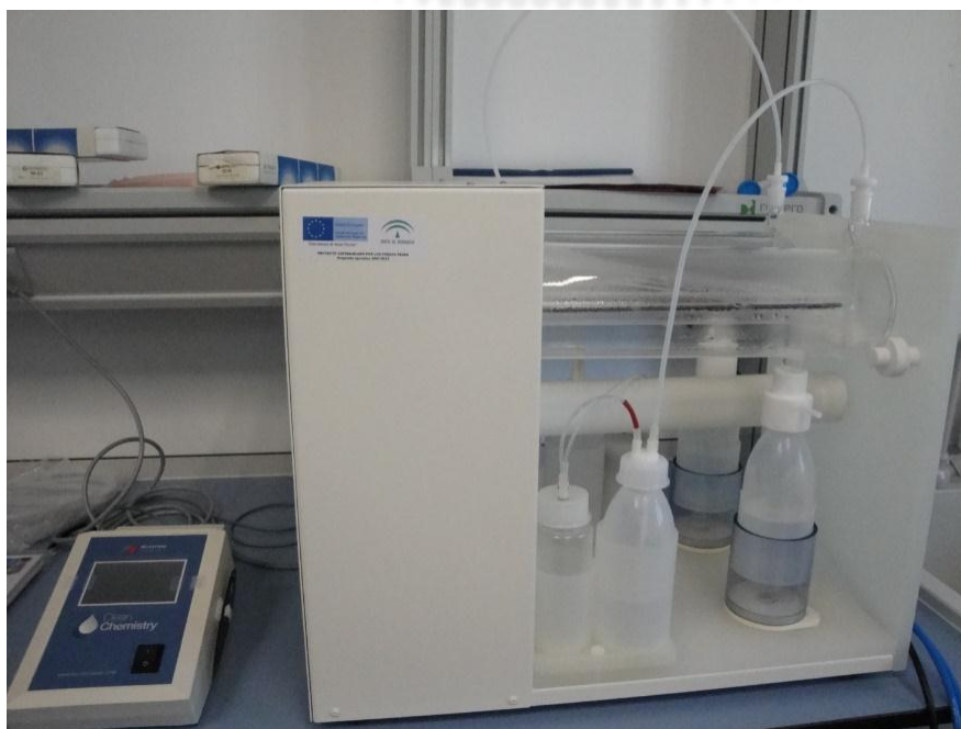
Figura 131: Destilador sub-boiling para purificación de reactivos ácidos de MILESTONE.
