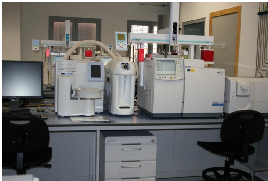
Figura 124: Sistema CG/MS/MS de BRUKER con acoplamiento de desorción térmica y sistema purga-trampa.
