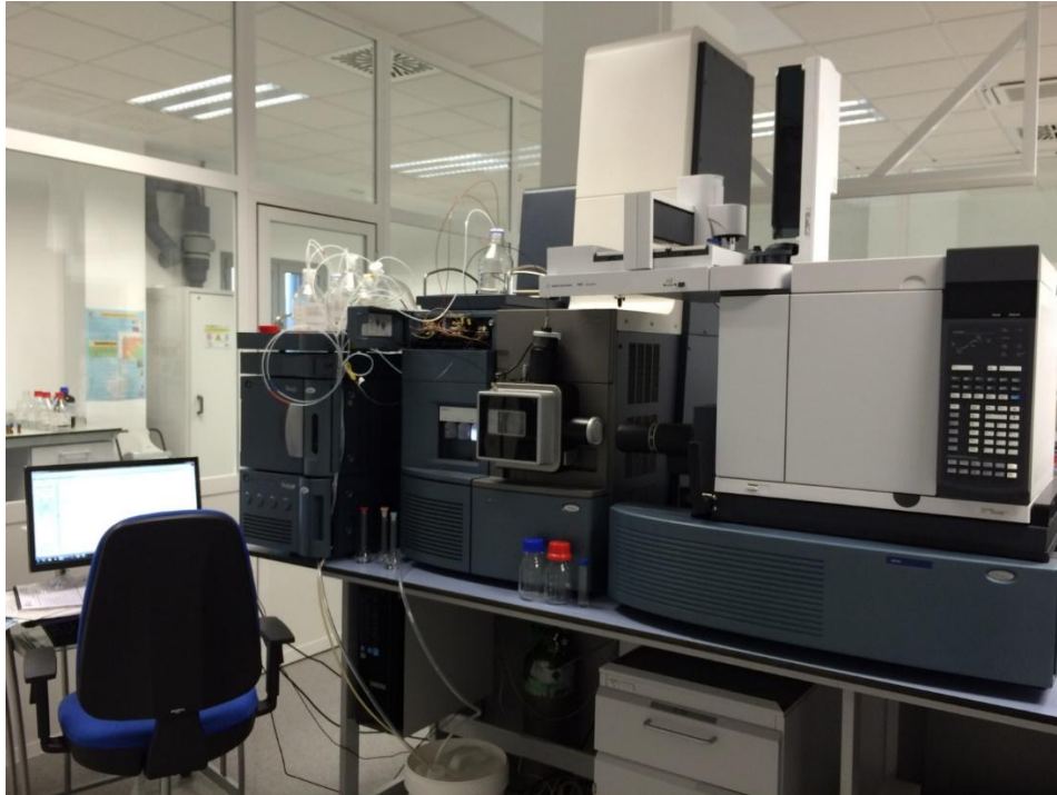
Figura 132: Espectrómetro de masas Q TOF acoplado a un sistema de cromatografía de gases a presión atmosférica y sistema UPLC de WATERS.
