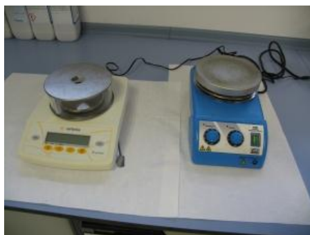
Figura 109: Agitador Magnético con calefactor VEP y Balanza de precisión Sartorius M-Power:
