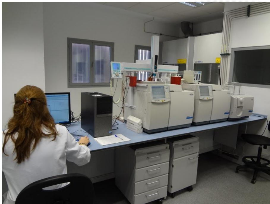
Figura 128: Rosario Toledano, técnico y responsable del SGI MCA, en el cromatógrafo bidimensional con olfatómetro.
