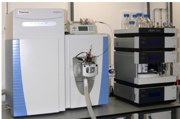
Figura 73: Espectrómetro de masas de alta resolución QExactive (izq.) y equipo de cromatografía líquida de ultra alta presión (UHPLC) (dcha.).
