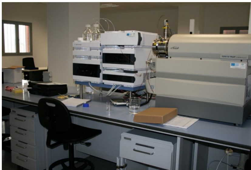
Figura 125: Sistema UPLC AGILENT serie 1290 con detector de masas Q-TRAP de ABSCIEX.
