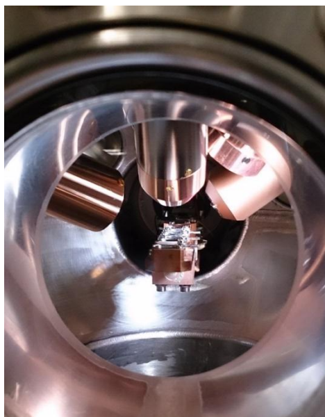
Figura 83: Detalle de cámara de análisis del espectrómetro de fotoelectrones SPECS PHOIBOS 150 MCD.
