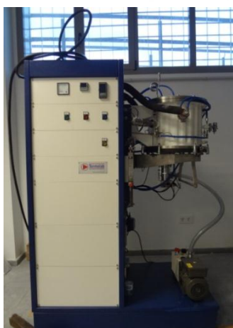
Figura 59: Horno de alta temperatura TA-2000°C.
