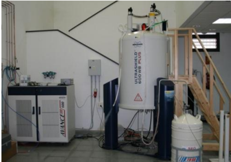
Figura 138: Detalle del espectrómetro Bruker Avance-600 WB de Sólidos.
