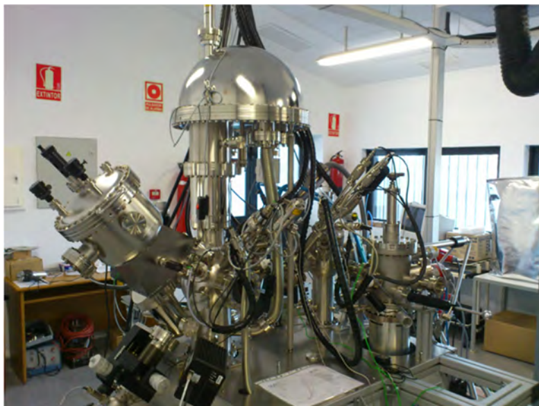
Figura 46: Sistema de espectroscopía de fotoelectrones "SPECS" Phoibos mod: 150 MCD.
