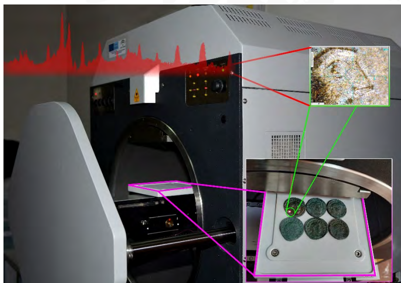
Figura 71: Ejemplo de montaje de muestras arqueológicas y resultado de medida en equipo FISCHER SCOPE.
