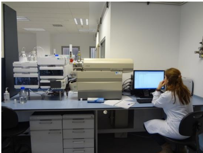
Figura 69: Sistema UPLC agilent serie 1290 con detector de masas Q-TRAP de absciex
