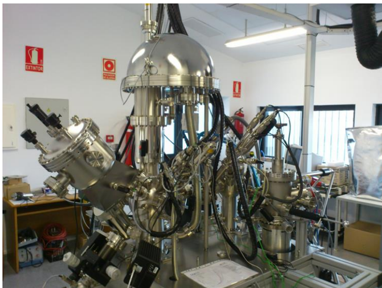
Figura 44: Sistema de espectroscopía de fotoelectrones "SPECS" phoibos mod: 150 MCD.
