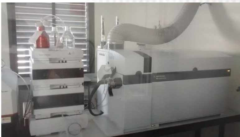
Figura 76: Sistema de espectrometría atómica de masas de triplie cuadrupolo Agilent ICP-QQQ 8800 junto al sistema de cromatografía on-line Agilent 1260. A la izquierda se aprecia el sistema de ablación LASER CETAC LSX-213+.
