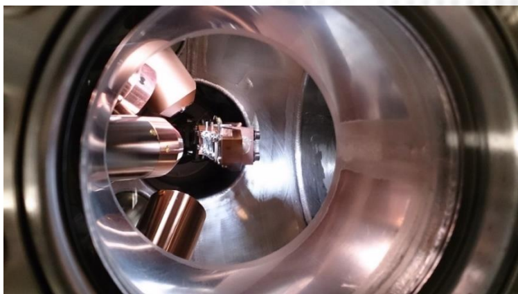
Figura 42: Cámaras de análisis, Specs Phoibos 150 MDC de ultra-alto vacío, que incorpora fuente de RX; técnica de ISS y el manipulador de muestras.
