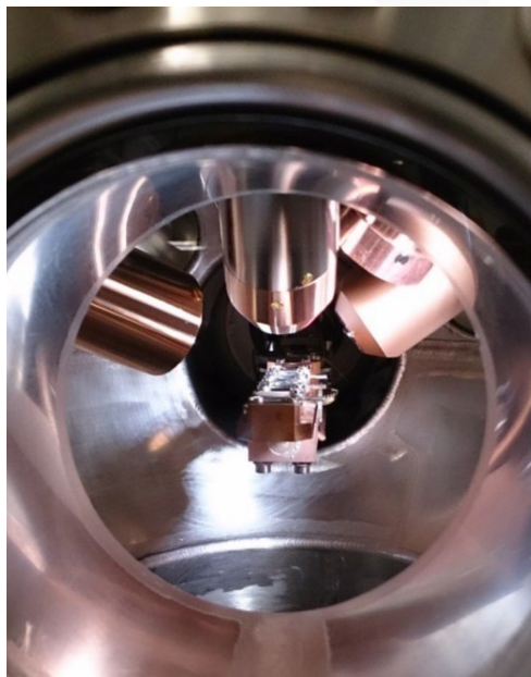
Figura 40: Cámaras de análisis, SPECs PHOIBOS 150 MDC de ultra-alto vacío, que incorpora fuente de RX; técnica de ISS y el manipulador de muestras.
