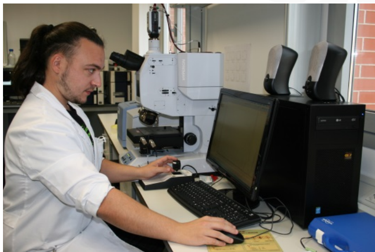
Figura 82: D. Rubén Parrilla Giráldez usando el Microscopio FTIR acoplado a espectrómetro IR.
