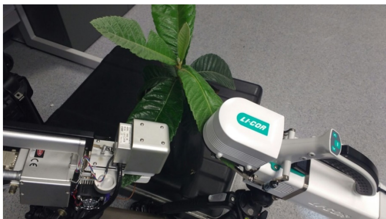
Figura 68: Medición de fotosíntesis usando los equipos Li Cor del SGI Invernadero.
