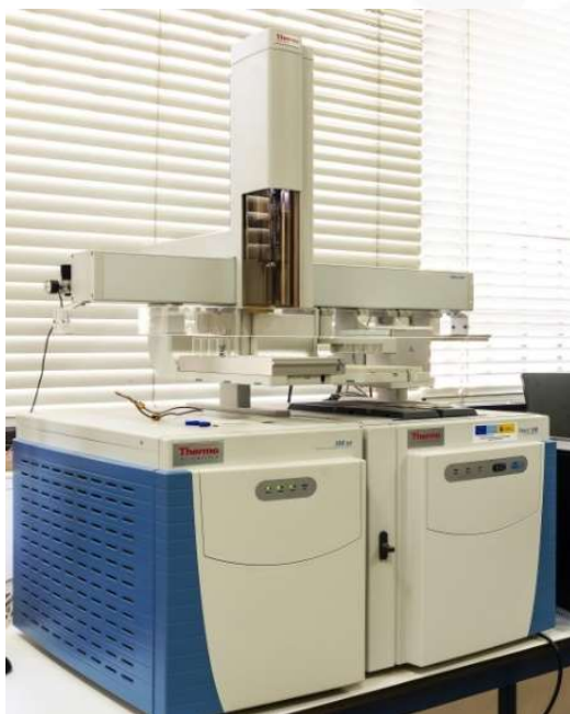
Figura 62: Cromatógrafo de gases masa Thermo-Scientific ISQ QD acoplado Trace 1300.
