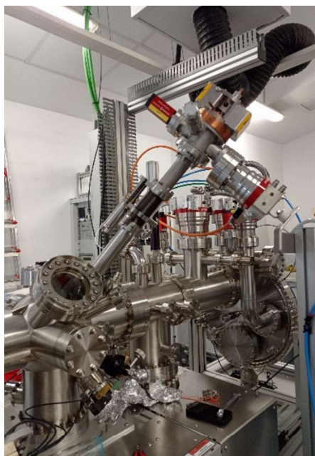
Figura 45: Detalle de la fuente de UPS
