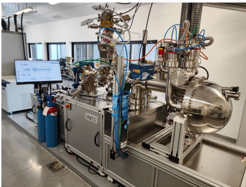
Figura 42: Equipo de espectroscopía de fotoelectrones NAP-XPS/UPS SPECS FlexPS-NAP PHOIBOS 150 1D DLD.
