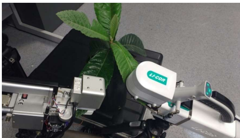
Figura 66: Medición de fotosíntesis usando los equipos Li Cor del SGI Invernadero.
