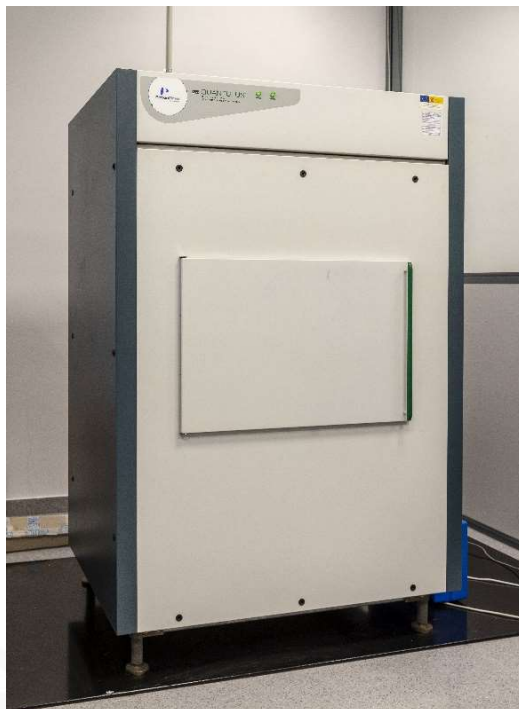
Figura 88: Espectrómetros de centelleo líquido Perkin Elmer Quantulus 1220 y Quantulus GCT 6220
