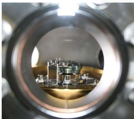
Figura 40: Detalle de cámara de alta temperatura y presión
