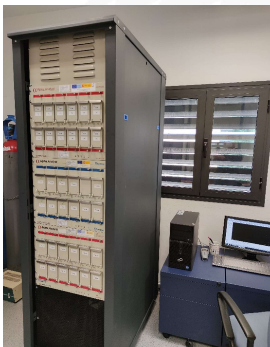
Figura 87: Espectrómetros de radiación alfa CANBERRA ALPHA ANALYST 7200-12
