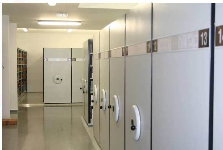
Figura 54: Sala de herbario equipada con armarios compactos Eypar para el almacenaje de los materiales del Herbario General y de los Herbarios Históricos de la Universidad de Sevilla. Sala climatizada a 20°C para el control de plagas.
