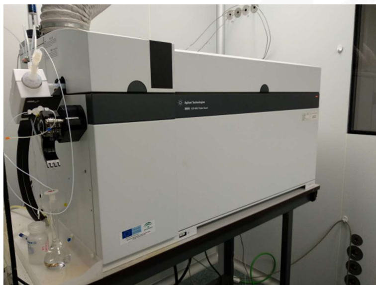
Figura 89: Espectrómetro atómico de masas ICP-MS/MS AGILENT 8800
