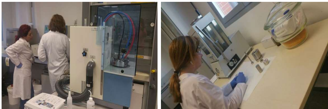
Figura 78: Izquierda: Rosario Toledano y Laura Vidal en el laboratorio de preparación de muestras. Derecha: Inmaculada Seijo preparando pastillas de KBr para FTIR.
