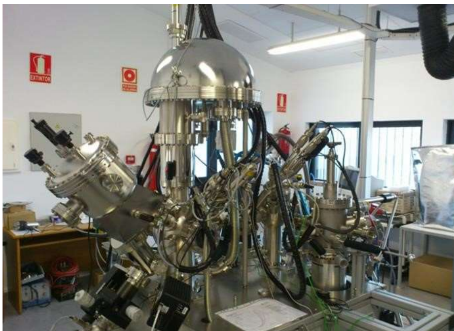
Figura 38: Espectrómetro de fotoelectrones SPECS PHOIBIOS 150 MCD .
