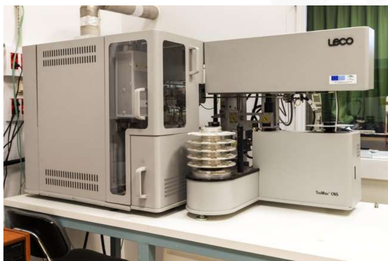
Figura 63: Autoanalizador elemental CNS-Trumac de LECO.
