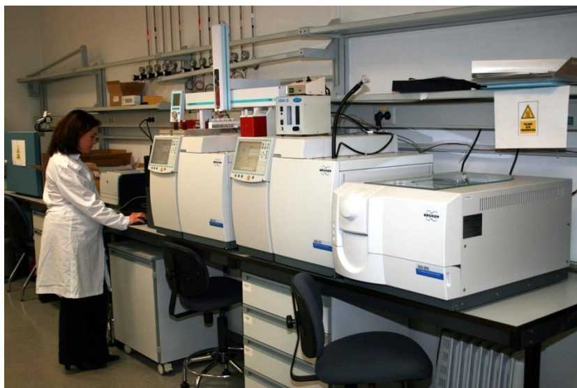
Figura 42: Laura Vidal, técnico de laboratorio del SGI MCA, en el cromatógrafo bidimensional con olfatómetro.
