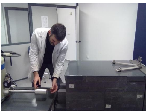
Figura 49: Santiago Hurtado, técnico de laboratorio del SGI RDI, cambiando una muestra en el detector gamma con geometría de pozo.
