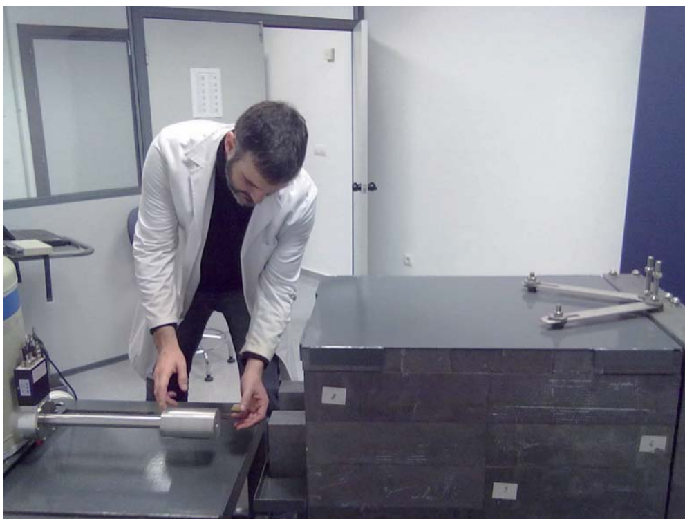
Figura 32: Santiago Hurtado, téc. de laboratorio del SGI RDI, cambiando una muestra en el detector gamma con geometría de pozo.
