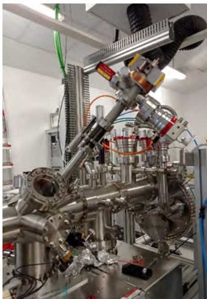
Figura 48: Detalle de la fuente de UPS
