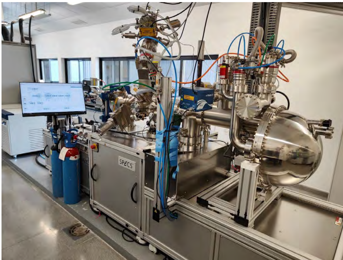
Figura 44: Equipo de espectroscopía de fotoelectrones NAP-XPS/UPS SPECS FlexPS-NAP PHOIBOS 150 1D DLD.
