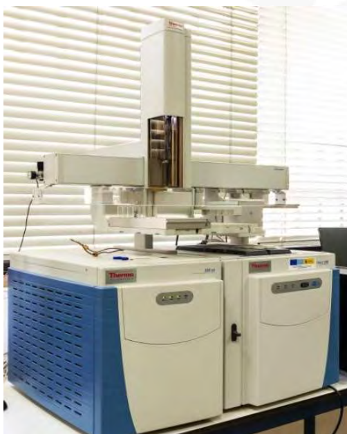
Figura 71: Cromatógrafo de gases masa Thermo-Scientific ISQ QD acoplado Trace 1300.
