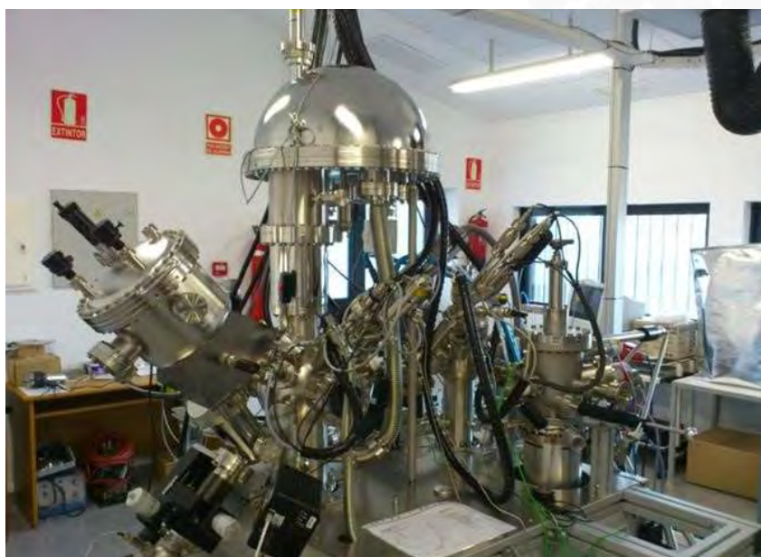
Figura 39: Espectrómetro de fotoelectrones SPECS PHOIBIOS 150 MCD.
