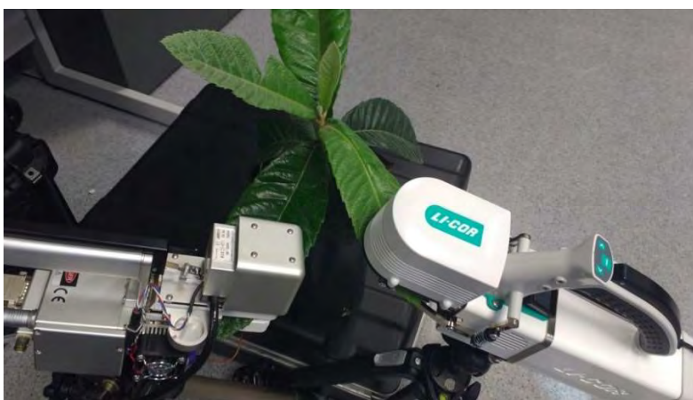
Figura 75: Medición de fotosíntesis usando los equipos Li Cor del SGI Invernadero.
