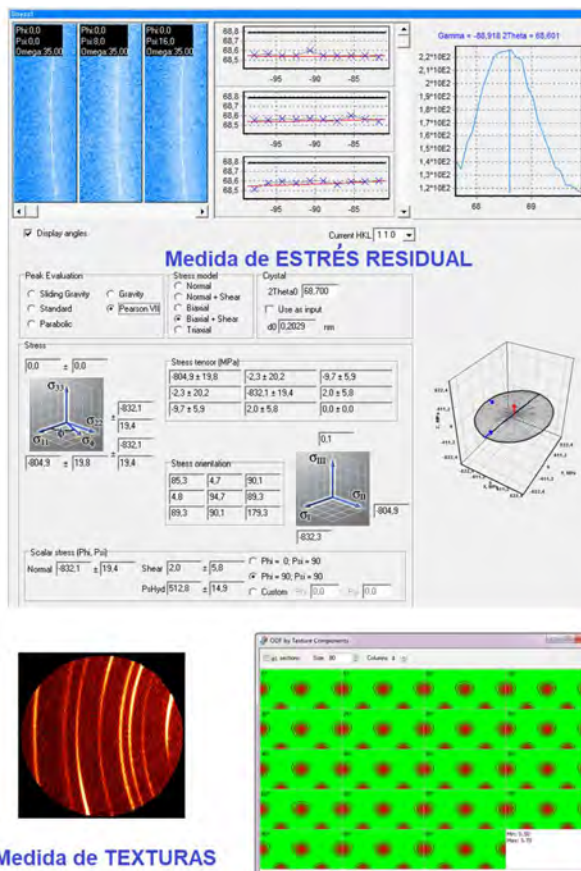
Figura 85: Determinación de Estrés residual y Texturas usando el Difractómetro D8 DISCOVER.
