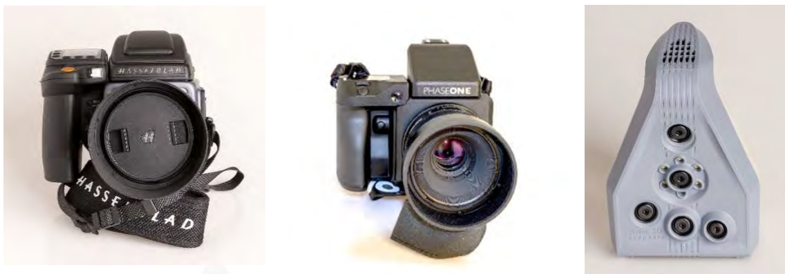
Figura 53: Equipos de digitalización. De izquierda a derecha: cámara fotográfica Hasselblad, cámara fotográfica Phase One XF y escáner 3d Artec Spider.
