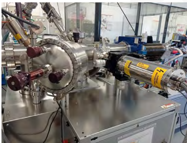
Figura 47: Detalle del conjunto de fuente de rayos X y monocromador.
