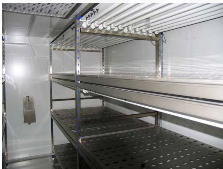
Figura 77: Interior de Cámara de Cultivo Fitoclíma 18000
