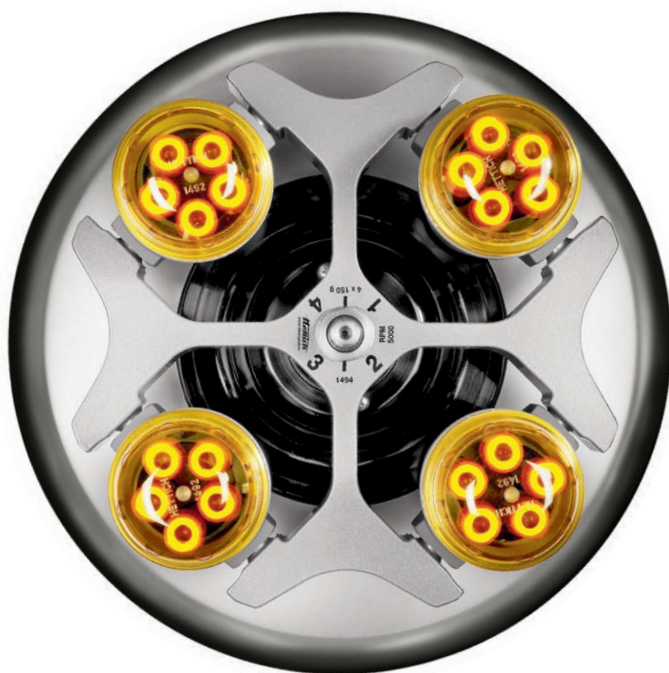
Vista del espacio de centrifugación muestra el rotor 1494 con recipientes para la extracción de sangre
